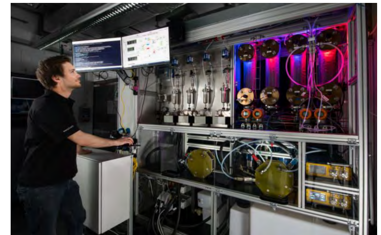
Beispiel AEL: ARTEMIS (2x 2 kW Alkaline Electrolyser testrig)
