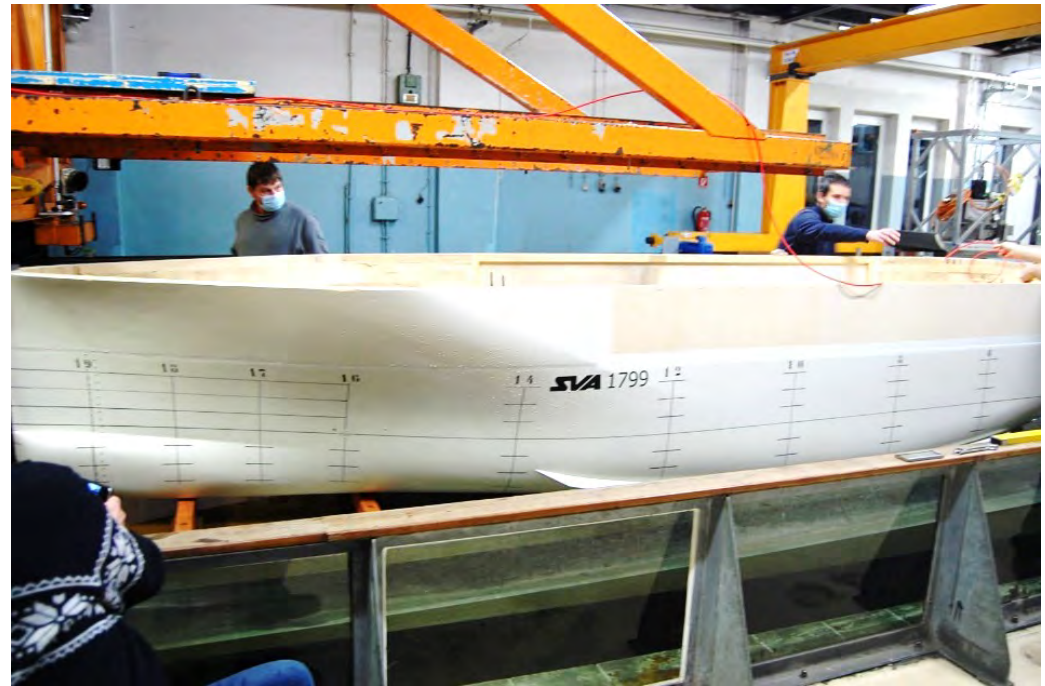
Model des Rumpfes (Maßstab: 1 : 6) – Schiffbauversuchsanstalt Potsdam, Feb. 2022, Foto: Volker Dzaak Hereon
